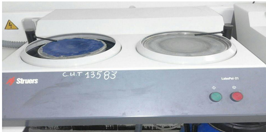
Figure 10 : Polisseuse mécanique à double disque (Modèle : Labo. Pol-21, V=250t/min )
