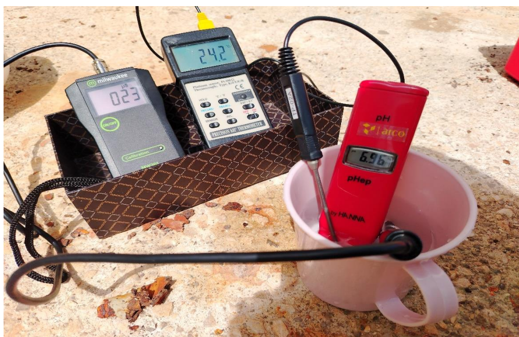
Figure A.2. Mesure de la conductivité, la température et le pH du perméat in situ
