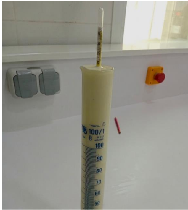
Figure 5. Mesure de la densité du lait par lactodensimètre (Gacem, 2026).
