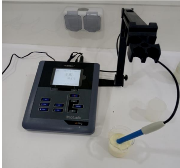
Figure 4. Détermination du pH du lait cru par le pH-mètre (Gacem, 2026).
