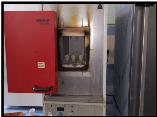
Figure 17: Incinération des échantillons de yaourt au Four à 500°C Figure 18: Photographie de cendres obtenues
