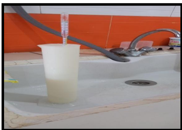
Figure 13 : Mesure La densité du lait à l'aide d'un densimètre
