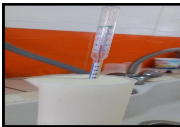
Figure 13 : Mesure La densité du lait à l'aide d'un densimètre
