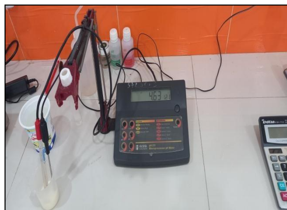
Figure 12: Mesure du pH des échantillons (lait + yaourt) analysés à l'aide d'un pH-mètre.
