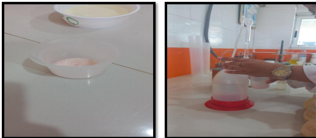
Figure 14 .Détermination de l'acidité de yaourt par titrage à l'aide d'hydroxyde de sodium
