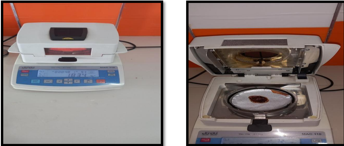
Figure 16 : Détermination de l'extrait sec total de produit à l'aide d'un dessiccateur infrarouge
