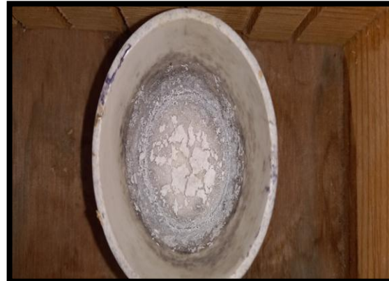
Figure 17: Incinération des échantillons de yaourt au Four à 500°C Figure 18: Photographie de cendres obtenues
