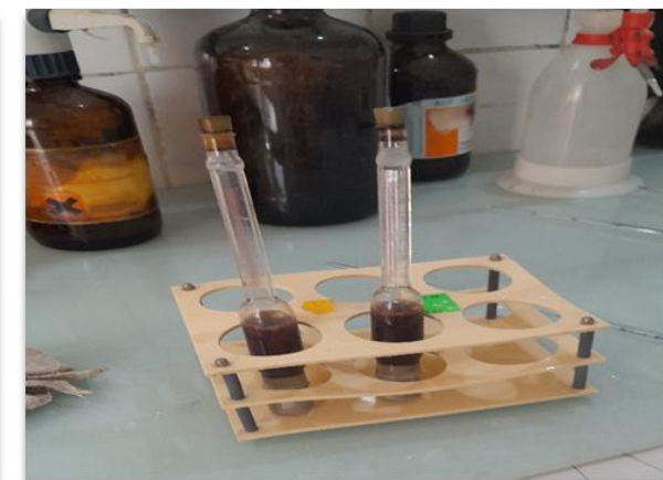
Figure 33.détermination du taux de la matière grasse (Harizi, 2024)
