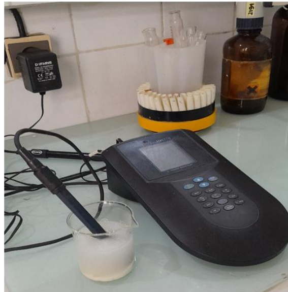
Figure 32. Mesure du pH du fromage (HARIZI, 2024)
