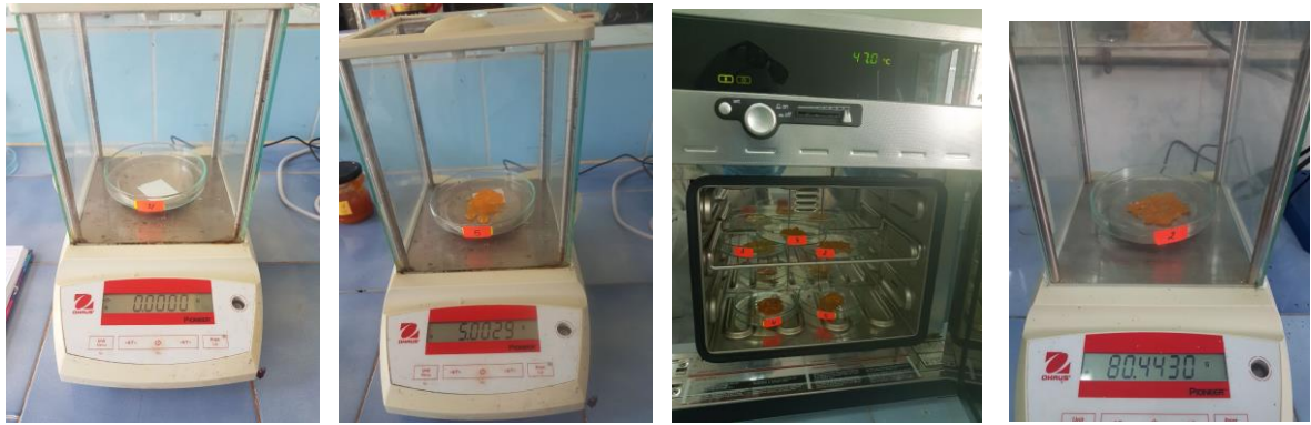
Figure 19. Détermination de la teneur en eau (Achouri R., 2024)
