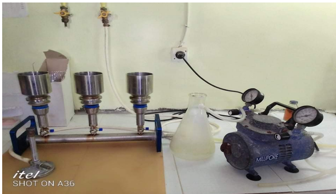
Figure 16 : Rampe de filtration. (Photo pers. 2022).
