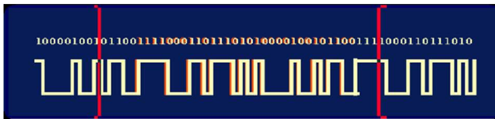
Figure 4 : Trame reçue décalée de façon à coïncider avec la trame générée: obtention du dt
