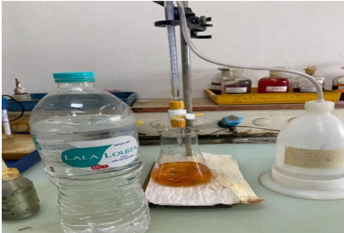
Figure 11: Détermination du titre alcalimétrique complet (TAC) (Mabrouki, 2026)
