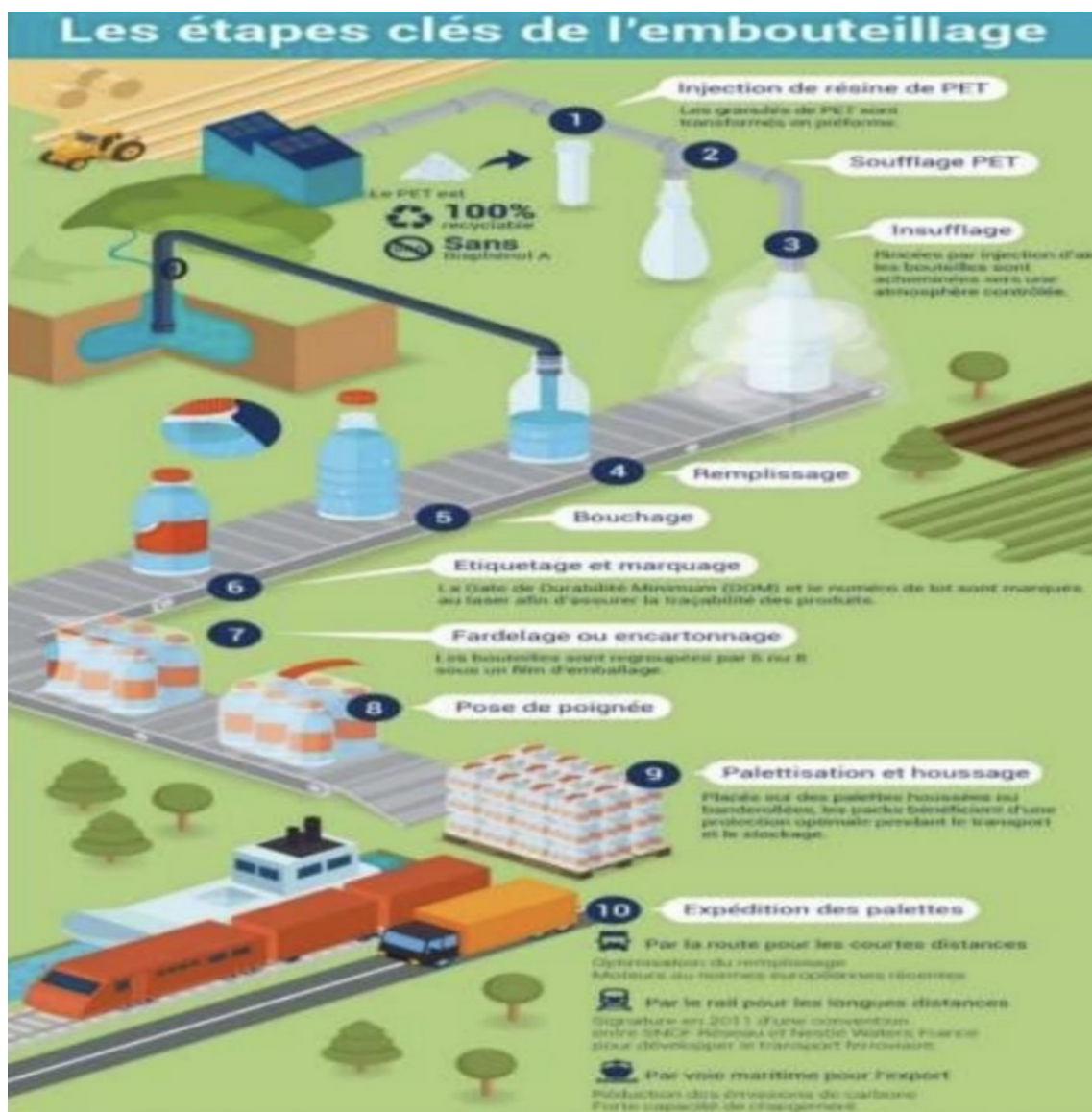
Figure 4: les étapes de l'embouteillage dans les unités de production des eaux embouteillées (Medfouni, 2019)
