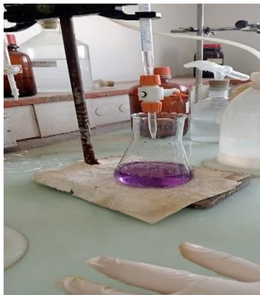
Figure 5 : Dosage des chlorures (Virage de la couleur de l'eau au bleu mauve) (Reggami, 2024)
