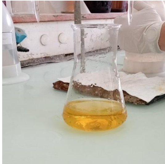
Figure 7 : Dosage des ions carbonates (Virage de la couleur de l'échantillon au jaune orangé) (Reggami, 2024)
