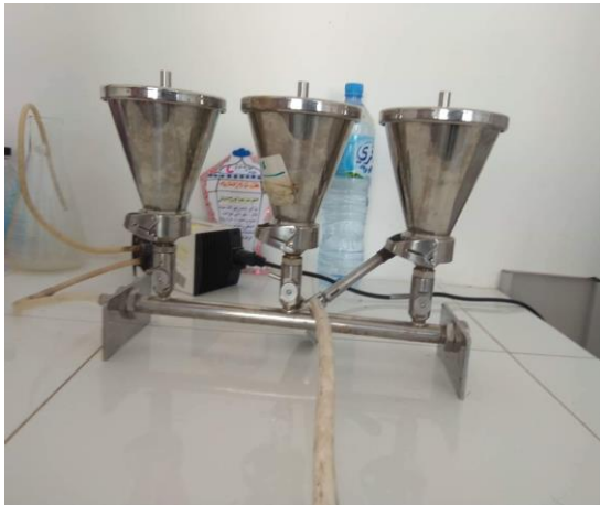
Figure n°5 : Rampe de filtration (Draoui S 2022)
