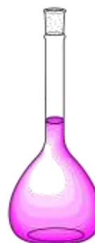
Figure III.16 : Fiole présentant une coloration rose en présence de \text{NO}_2^- .
