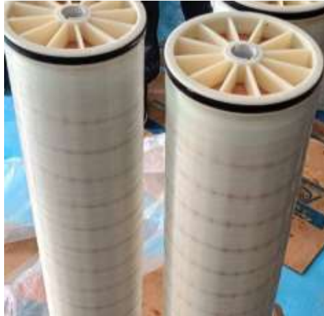
Figure II.13 : Éléments filtrants pour osmose inverse.
