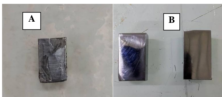
Figure II.18. L'acier X70 avant (A) et après (B) le polissage.
