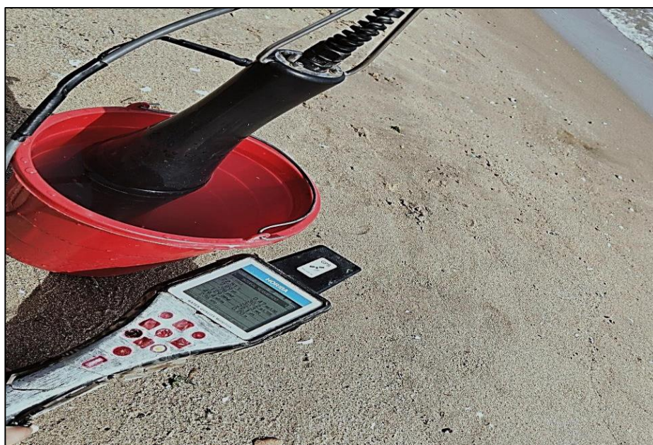
Figure 06 : Mesure de la température , Conductivité, PH , DO , TDS, Turbidité , Salinité
