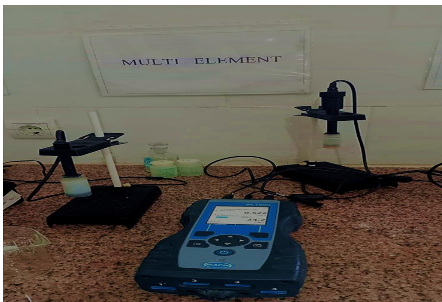
Figure 07 : Mesure de \text{NO}_3^- , et \text{NH}_4^+
