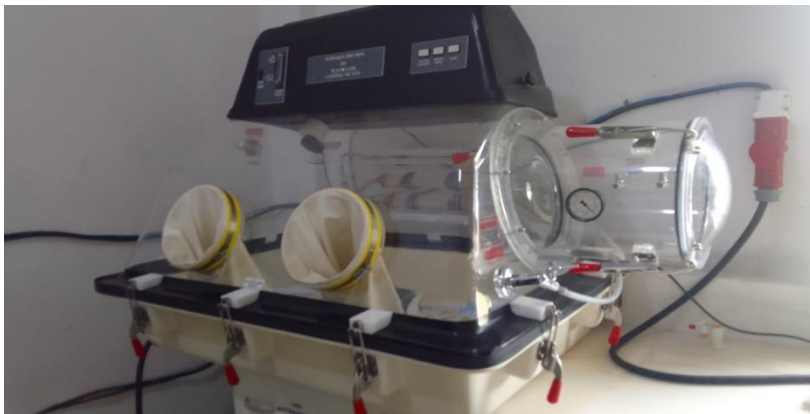
Figure 15 : Boite à gants du LRPCM-UCBET
