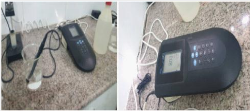
Fig. 4 : Mesure du pH et de la température
