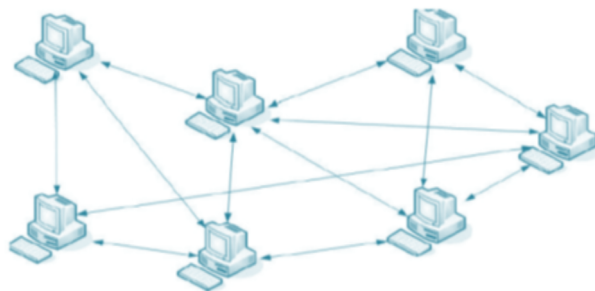
Figure 4. Exemple d'architecture décentralisée.
