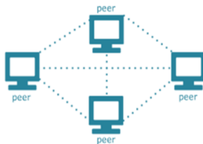
Figure 1. Structure du réseau P2P.
