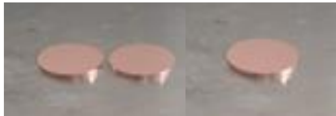
Figure II. 3 : Pastilles cylindrique après pressage uniaxial.
