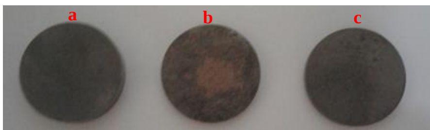
Figure II. 6 : pastilles frittées à différentes températures (a) 400°C (b) 450°C et (c) 500°C
