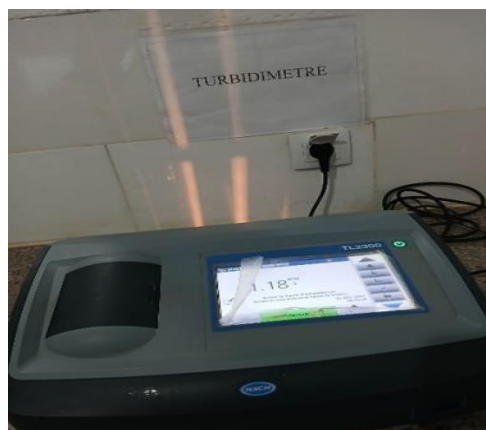
Figure 07. Mesure de la turbidité
