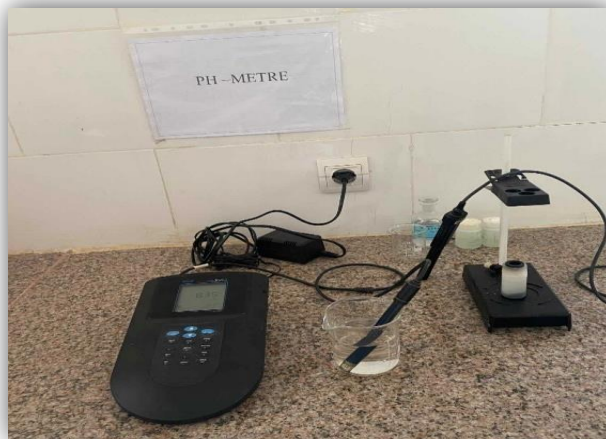
Figure 05. Mesure du pH
