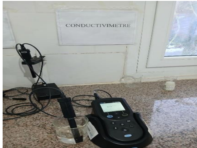
Figure 06. Mesure de la conductivité électrique
