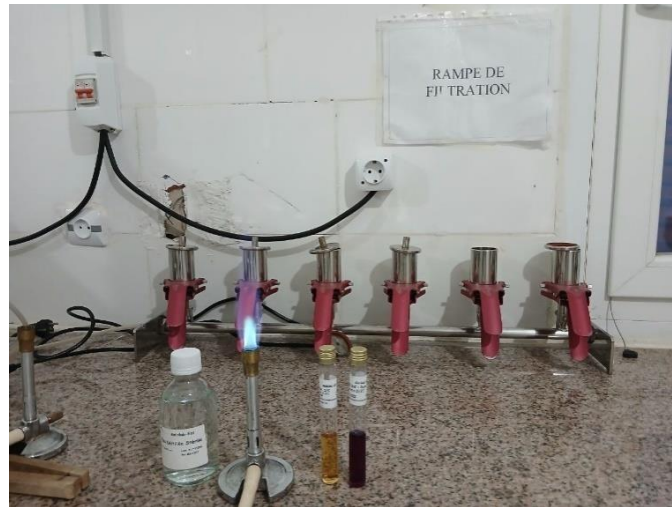
Figure 12. Filtration sur membrane (photo originale).
