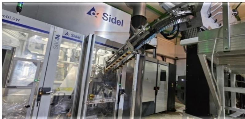
Figure 3: Chauffages et soufflage des préformes (Abdou M, 2026).
