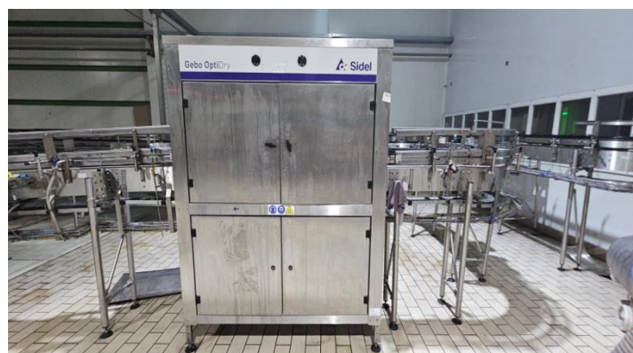
Figure 6: L'appareil de séchage avant l'étiquetage (Abdou M, 2026).
