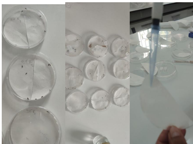
Figure 19. Dispositif du test de l'évaluation de l'effet répulsif d'HE.
