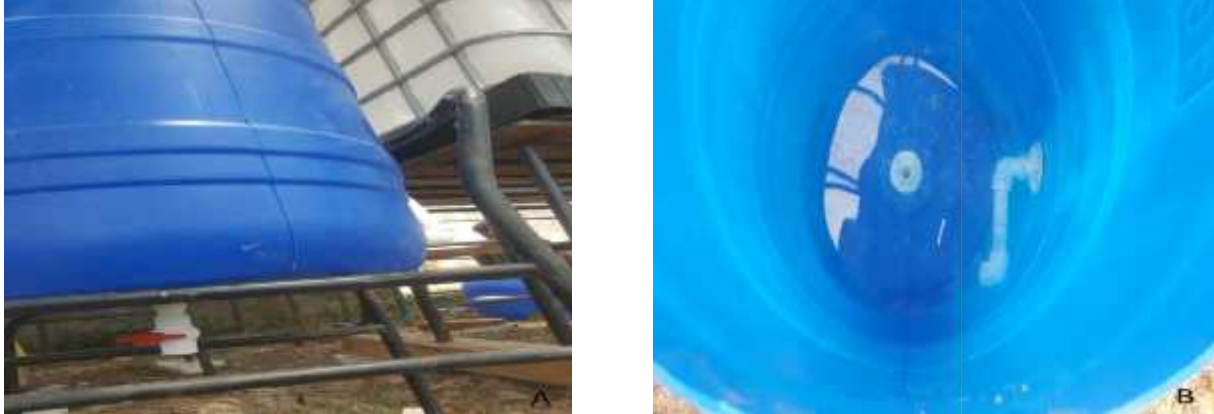
Figure 10 : Filtre à tourbillon (A : vue externe ; B : vue interne) (Boustila, 2021)
