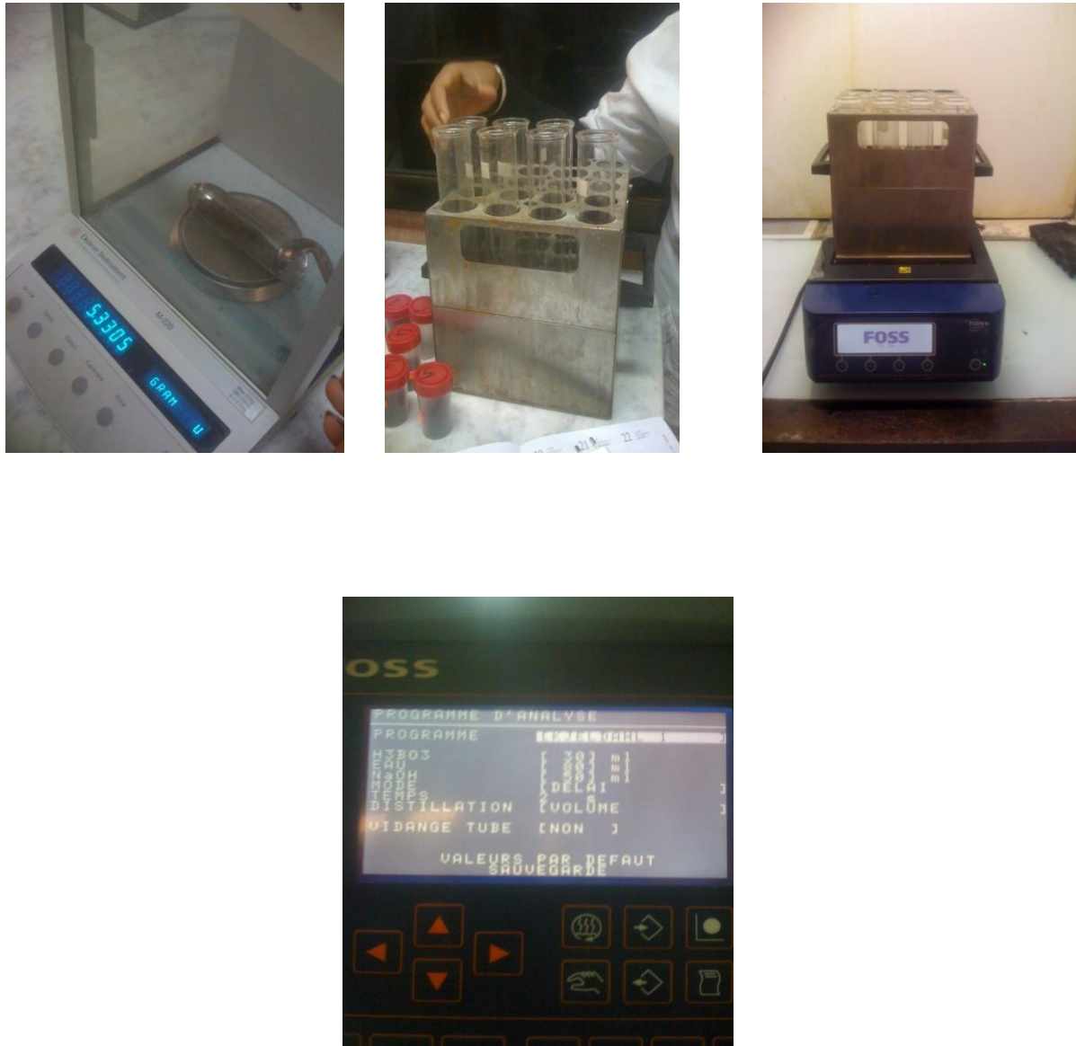
Photo.11: Dosage de l'azote par la méthode de Foss Kjeltec 2400
