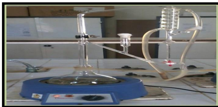
Figure 13 :L'extraction des huiles essentielles par l'hydro_ distillation.
