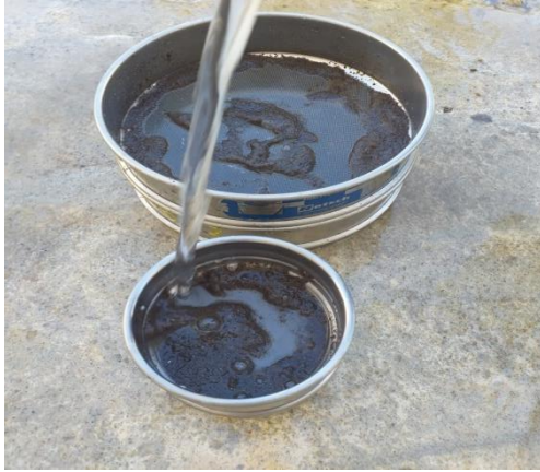
Figure 15 : Le recueil des tamisats de chaque tamis dans des flacons (33cl) étiquetés (Boussaha et oubetroune, 2023).
