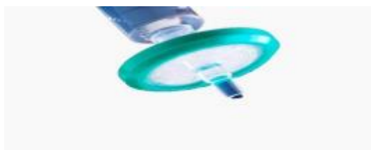
Figure IV.9. Un filtre seringue
