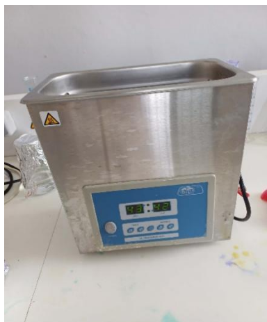
Figure IV.10. Bain à ultrasons
