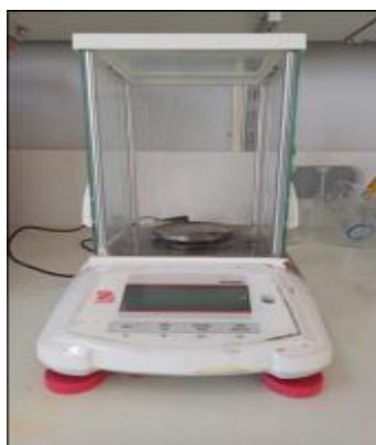
Figure IV.5. Une balance analytique de la marque OHAUS
