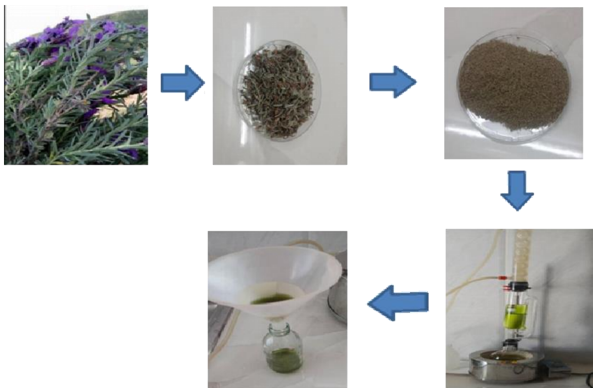
Figure IV.2. Schéma détaillé des différentes étapes de préparation de la plante Lavandula stoechas et de l'extraction des composés bioactifs utilisés pour la biosynthèse des nanoparticules de fer (FeNPs).
