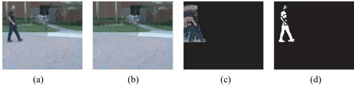
Figure 6: Soustraction de fond en utilisant des mixtures de Gaussiennes [11]
