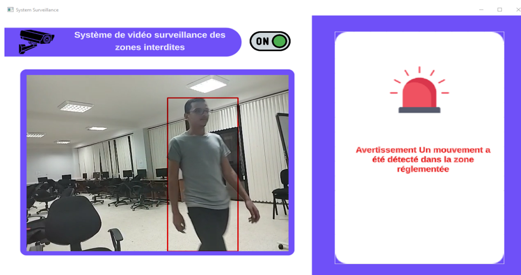
Figure 26: Testez le système si un mouvement est détecté dans la zone
