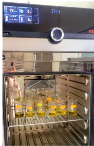
Placé dans l'étuve 103°C durant 1h
