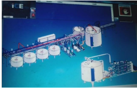
Photo III.1 : Interface de supervision du procédé de traitement (Medaci Dina 2026)
