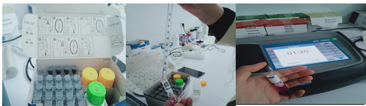
Photo III. 11 : Etapes d'analyse de la dureté (Medaci Dina 2026).
