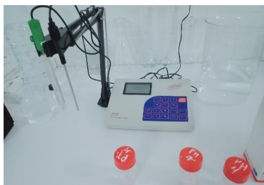
Photo III 7 : pH-mètre employé pour la mesure du pH (Medaci Dina 2026).
