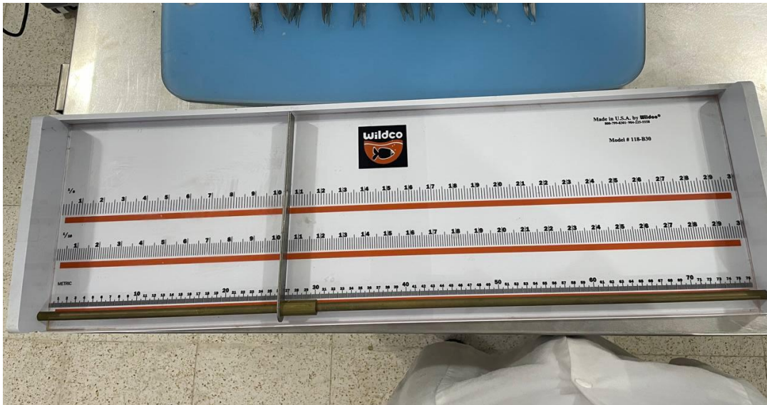
Figure N°08 : Règle ichtyométrique pour mesurer la longueur totale des poissons (CHOUADRIA, 2025)
