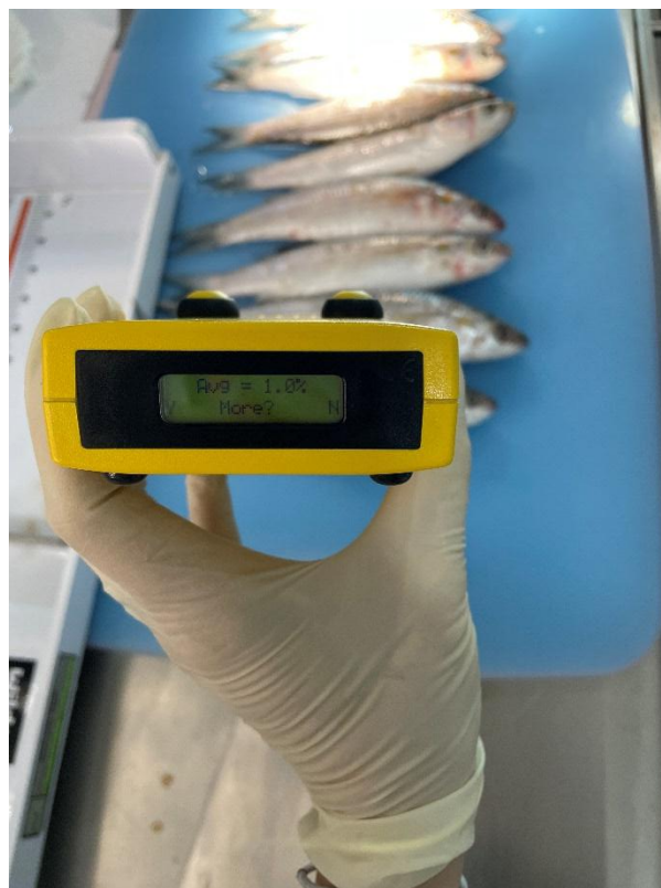
Figure N°18 : résultat final (8 ème ) de la mesure du taux de graisse chez le mullet avec le FISH FATMETRE (CHOUADRIA, 2025).
