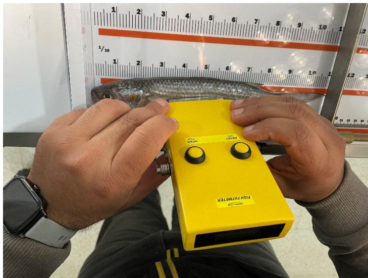
Figure N°16 : Mesure du taux de graisse d'un mullet ( Mugil cephalus ) à l'aide d'un FISH FATMETRE (CHOUADRIA, 2025)
