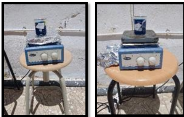
Figure II.8. Montage expérimental de dégradation du vert de malachite sous irradiation solaire
