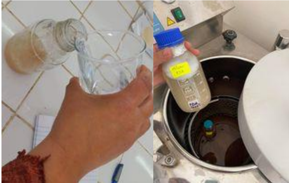
Figure 12.a): la dilution du bouillon avec l'eau distillé, b): l'autoclavage du milieu (Merdaci & Chibani, 2023)
