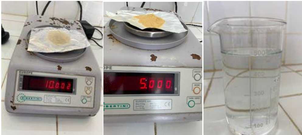
Figure 8. Préparation du milieu Malt -Agar, a) :Agar-agar, b) : Malte , c) : eau distillé (Merdaci & Chibani, 2023)
