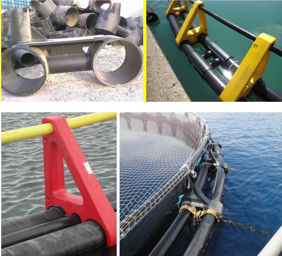
Figure 9. Les chandeliers d'une cage flottante.
