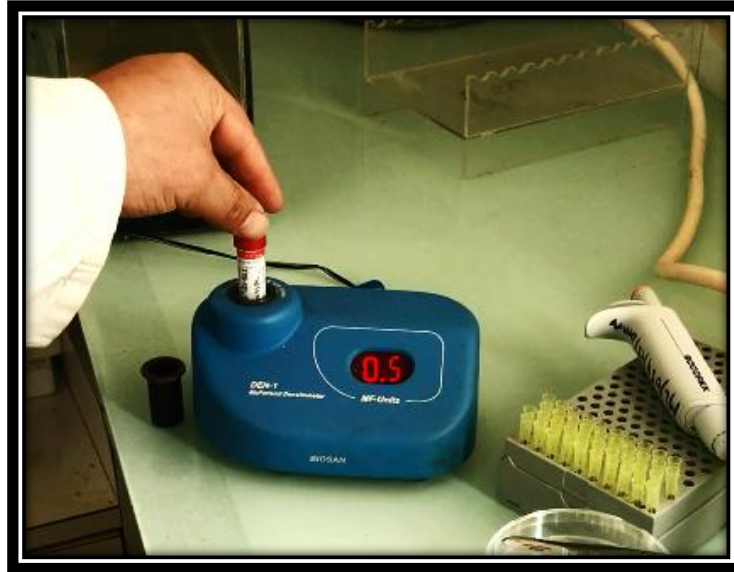
Figure 29: Lecture la DO de l'inoculum à l'aide d'un densitomètre
