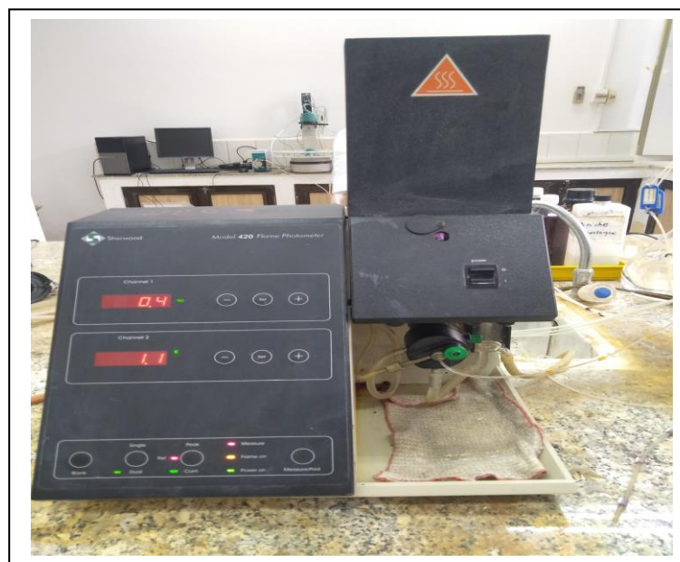
Figure 25 : Le spectrophotomètre démission de flammes (Flidjane, 2026)
