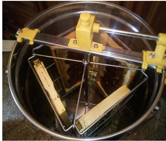
Figure 21. Opération d'extraction du miel par extracteur centrifugeuse
