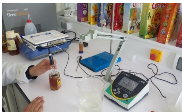
Figure 27. Mesure du pH par le pH mètre
