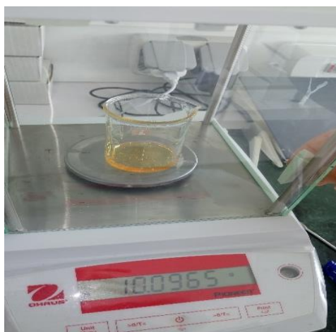
Figure 31. Pesée du miel sur une balance de précision
