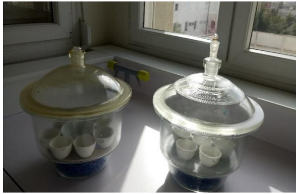
Figure 36. Les capsules avec les cendres dans le dessiccateur
