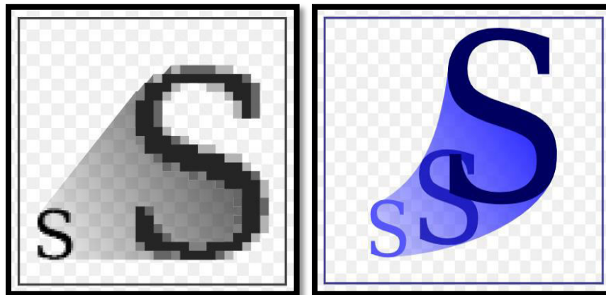
Figure 1.3. Agrandissement d'une image matricielle et d'une image vectorielle
