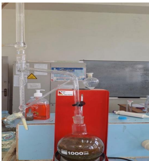
Photo 05. Appareil d'hydrodistillateur de type Clevenger (Taguida et Dine, 2026)
