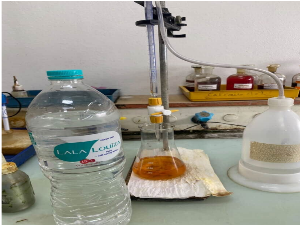
Figure 8 : Détermination du titre alcalimétrique complet (TAC) (Mabrouki, 2026)
