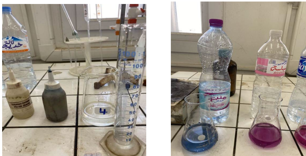
Figure 6 : Détermination du titre hydrotimétrique (Dureté de l'eau) (Mabrouki, 2026)
