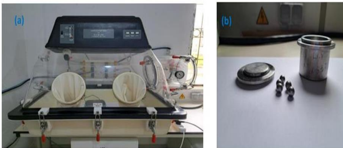
Figure II.4 : (a) Boîte à gant type Plas-LabsInc, sous atmosphère d'argon et (b) des outils de broyage.
