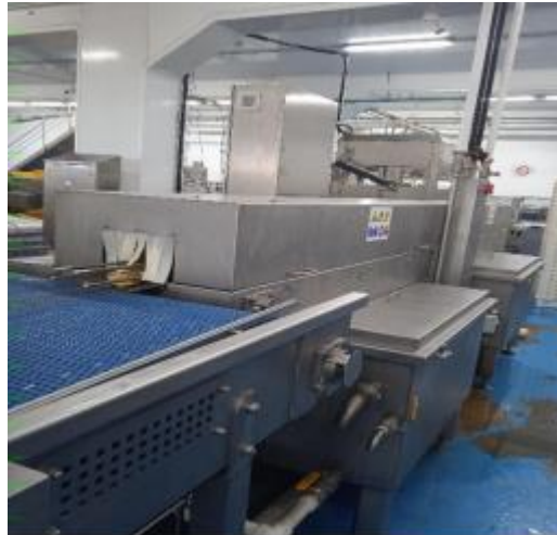
Figure 17 : Lavage des boîtes
