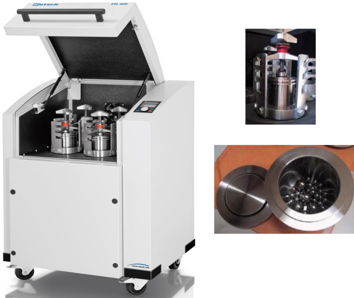
Figure II.2 : Broyeur planétaire, de marque commerciale Retsch PM 400 (modèle Pulvérisette 7), utilisé pour la mécanosynthèse des alliages.
