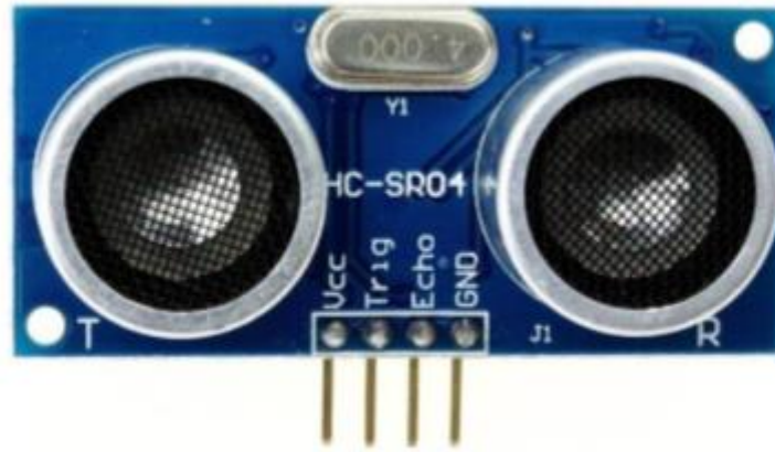
Figure 3.3. Capteur ultrason HC-SR04
