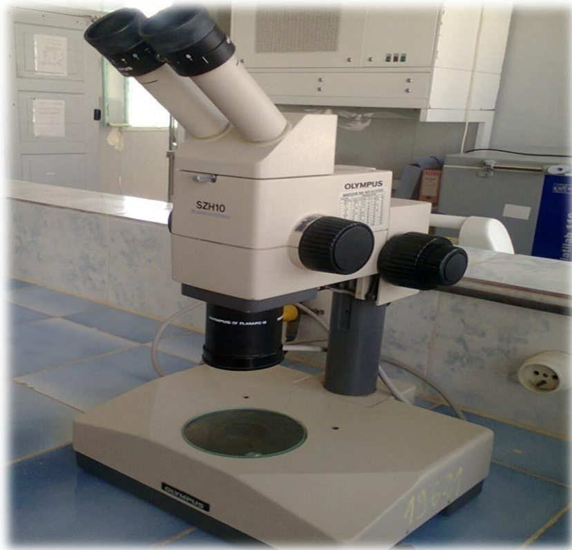
Figure 5: Photographie d'un stéréo microscope (Olympus SZX 10),
