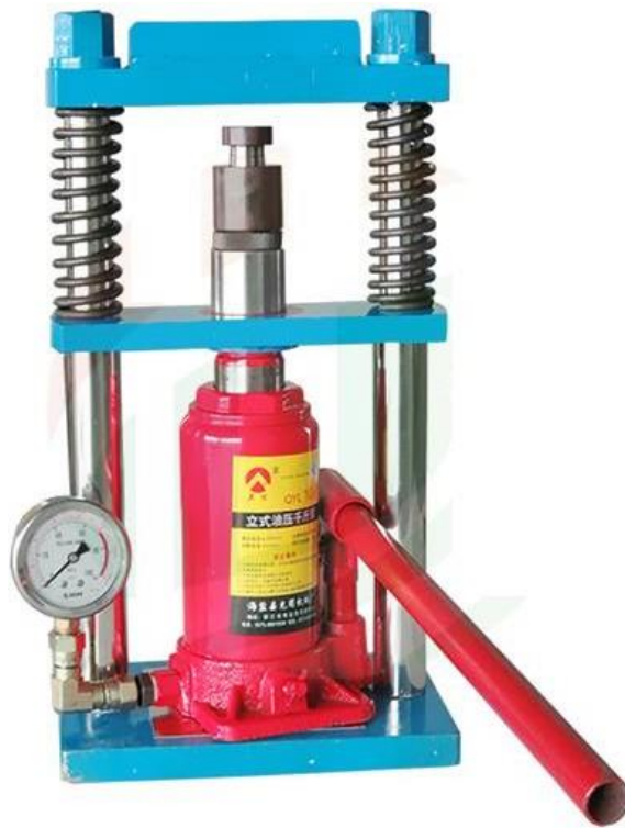
Figure II. 2 : Presse hydrostatique utilisée pour la préparation des pastilles
