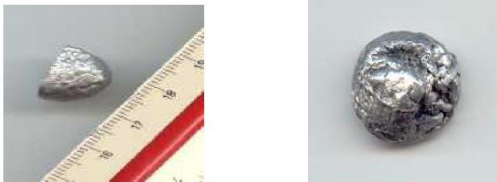
Figure III-4: Alliage Al-Zn-Mg à l'état brut après élaboration
