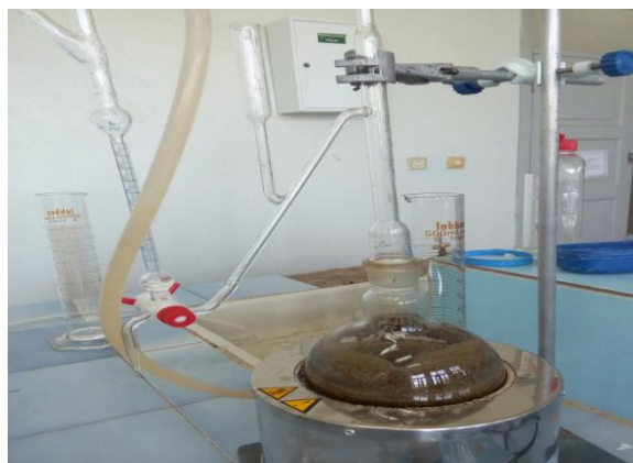
Figure22 :Hydrodistillateur (Douakha, F., et Hamdaoui., 2017).
