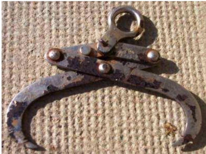
Photo 52 : Crochet de Huynen fermé
