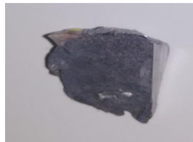
Figure II-5 : Alliage ternaire Al-Zn-Mg découpé.
