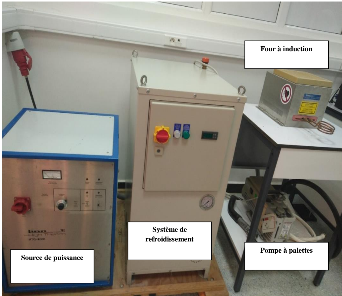
Figure II-2 : Principaux constituants du générateur haute fréquence (HF).
