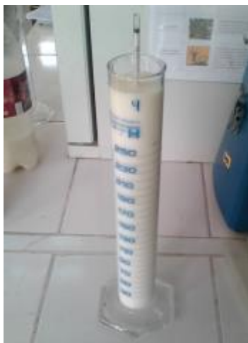
Figure 14. Détermination de la densité par le lactodensimètre
